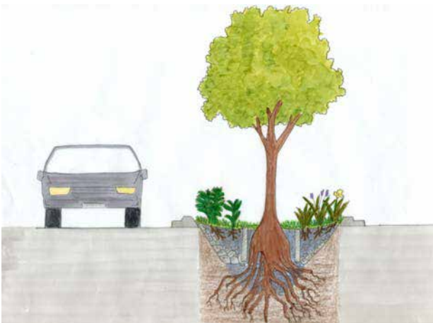
Ilustración 23 Detalle esquemático de jardín de lluvia. Gráfico de elaboración propia Contexto Ambiental
